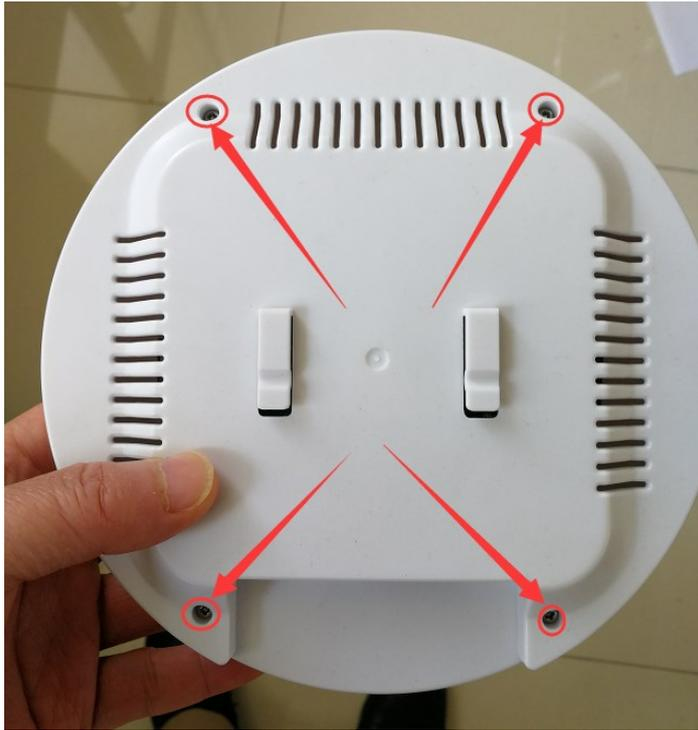
基站背面有 4 个螺钉，使用螺丝刀拆下 4 个螺钉，即可分离基站上盖和底盖。
