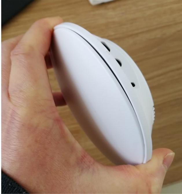
上图是使用左手食指和拇指用力捏外壳的边缘，上盖和底盖会受力变形，然后上盖与底盖之间会出现一个缝隙。用右手拇指指甲从缝隙把上盖扒开即可。
